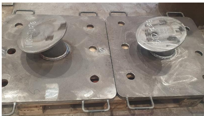
Tv Søndre forankringspunkt. Th Nordre forankringspunkt, Ferdig støp og overflaten er glattet og plan. Forskalingene er revet.
